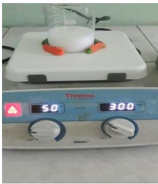
3. Masukkan semua minyak dan KOH sampai terbentuk pasta, masukkan asam stearat, campuran BHT dan HPMC ad homogen lalu ditambahkan gliserin dan aquades.
