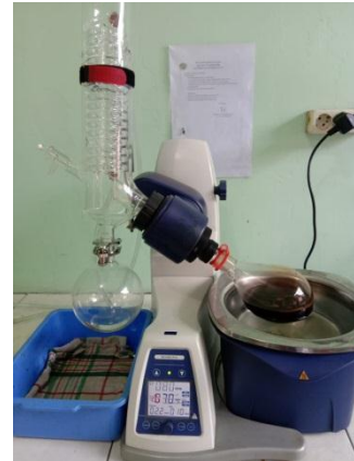
3. Hasil maserasi di rotari untuk mengurangi kandungan etanol
