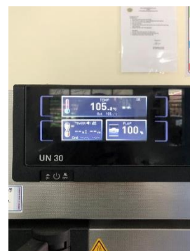
6. uji kadar air minyak dengan oven suhu 105 0 C selama 1 jam
