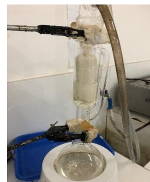
6. proses ekstraksi soxhlet dengan pelarut n-heksan sebanyak 300ml suhu 80-100°C
