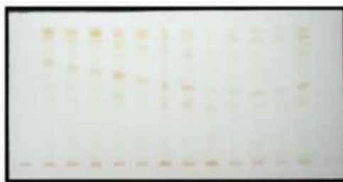
Pelat No.1 [Cahaya putih] Gambar pita di pelat gel silika setelah dicelupkan Perseki Gibb di bawah cahaya monokromatik
