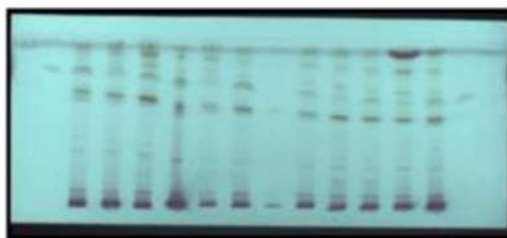
Pelat No. 2 [Sinar UV] Gambar pita di pelat gel silika setelah melewati Gibb's reagen, udara kering dan uap ammonia berturut-turut di bawah sinar ultra-violet
