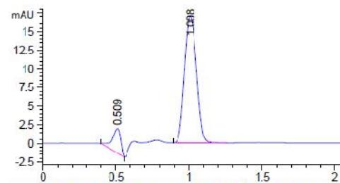
Gambar 5. Kromatogram klorpirifos pada volume injeksi sampel 15  $\mu\text{L}$
