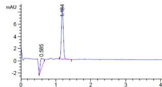
Gambar 3. Kromatogram lorpirifos pada komposisi fasa gerak air : asetonitril (10 : 90)
